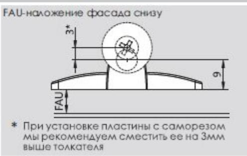
\* При установке пластины с саморезом мы рекомендуем сместить ее на 3мм выше толкателя
