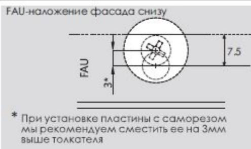
\* При установке пластины с саморезом мы рекомендуем сместить ее на 3мм выше толкателя
